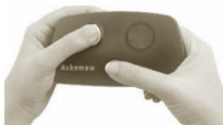
**Schritt 3:** Lassen Sie die „Sicherheit“-Taste los. Drücken Sie weiterhin mit Ihrem linken Daumen auf die „Mähen“-Taste. Steuern und bewegen Sie den Robomow, indem Sie mit Ihrem rechten Daumen auf die Navigatorschaltfläche drücken. Wenn Sie die Mähen-Taste loslassen, stoppt/stoppen die Klinge/n. Sie müssen die obigen Schritte wiederholen, um das Mähwerk erneut zu aktivieren.
