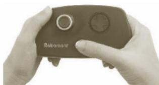
**Schritt 2:** Drücken Sie, während Sie die „Sicherheit“-Taste drücken, mit Ihrem linken Daumen auf die „Mähen“-Taste. Hierdurch wird/ werden die Klinge/n aktiviert.
